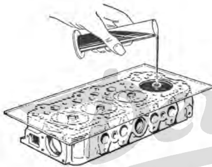
Contrôle du volume d'une chambre
