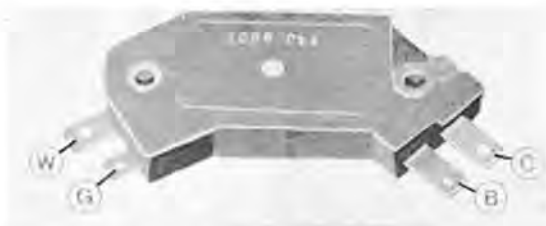
Repérage des bornes du module amplificateur G. et W. Bornes reliées au capteur d'impulsions magnétiques de l'allumeur. B. Borne reliée à l'alimentation (+ 12 V) de la bobine - C. Borne reliée à la borne (-) de la bobine
