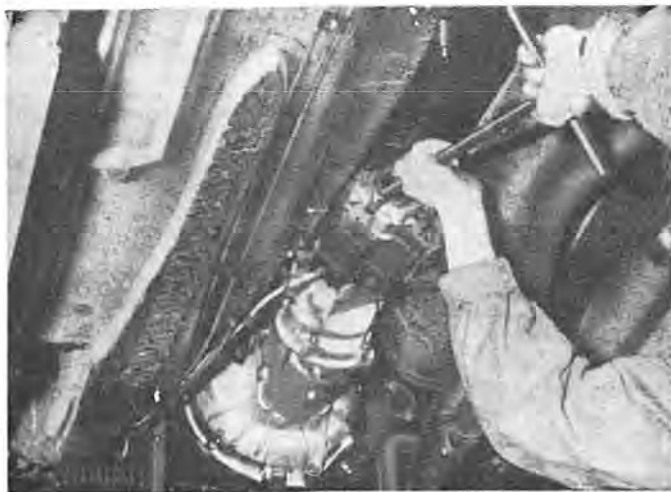
Dévisser les quatre vis d'assemblage du couvercle de rotule de poussée
