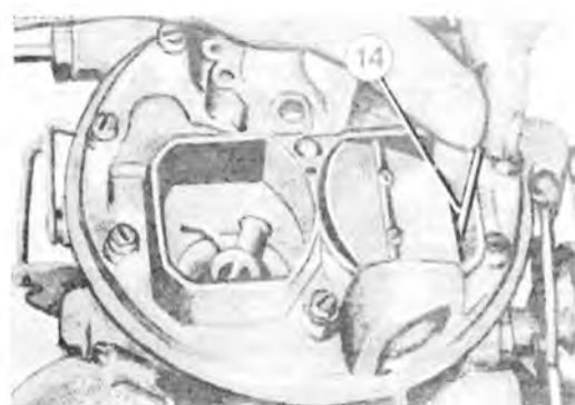
Réglage de l'ouverture du volet de départ à l'aide d'un foret (14) de 3,5 mm
