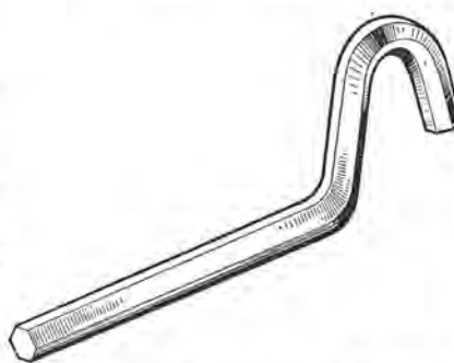
Clé Allen (8 0202) pour dépose des vis de fixation du carter d'embrayage
