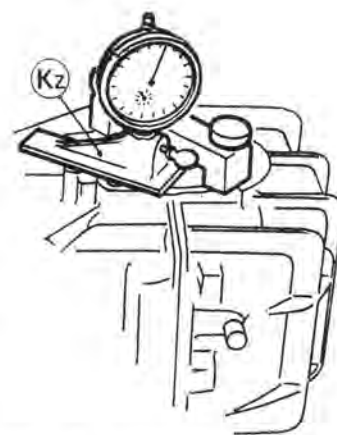
Contrôle de la hauteur du plan de joint par rapport au roulement
