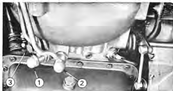
Montage des raccords sur convertisseur de couple (boîte ZF)
